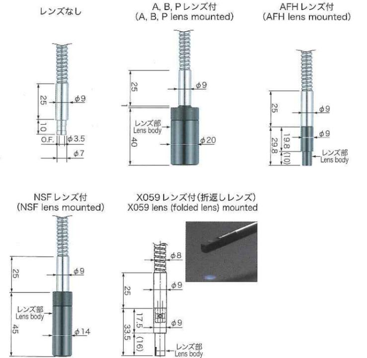
標準タイプのAFファイバに、それぞれ照射距離や照射径の異なる先端レンズ“A”、“B”、“P”や、狭い場所にも届きやすい極細タイプのレンズを組み合わせでき、多彩なUV照射が可能です。
