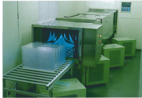
某製薬工場様 充填室搬入前の容器の包装物の殺菌 ■高出力表面殺菌装置200W3灯用×4台
