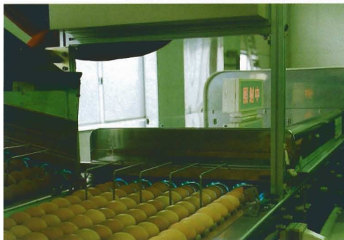
ノーサンエッグ(株)様 タマゴの表面殺菌 ■中出力表面殺菌装置65W×7灯用(特注照射器)
