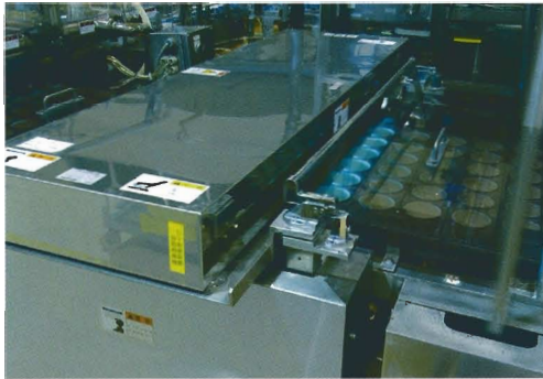
(株)ヤクルト本社 札幌工場様 充填前の容器の表面殺菌 ■高出力表面殺菌装置400W×6灯用
